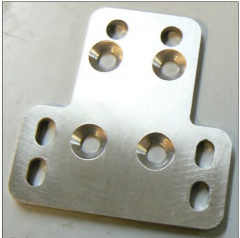
La plaque après polissage et fraisage des têtes de vis. ATTENTION au fraisage, la tête de vis d'origine fait 9mm et la tête des vis inox normalisées est de 8mm
