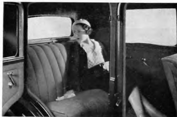
Vue des places arrière de la Berline 8 CV. Le store de lunette AR est commandé des places AV.
