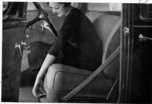
Les sièges avant sont réglables. Sans descendre du siège, par simple manœuvre d'une manette, on peut le déplacer.
