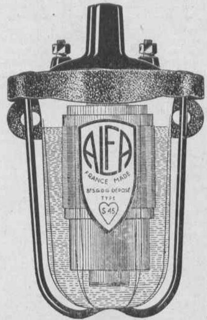
Fig. 17. — BOBINE A HUILE ALFA. L'étanchéité est obtenue par un joint de caoutchouc serré entre le boîtier de verre et la tête de bobine.
