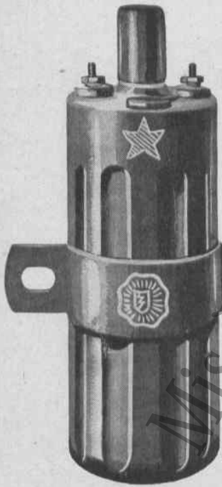
Fig. 15. — BOBINE A HUILE PARIS-RHONE, TYPE ETOILE. L'étanchéité du boîtier en métal est obtenue par sertissage.
