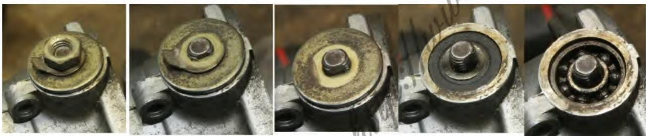
Arrivé à ce stade , en tapant légèrement sur le bout de l'axe après avoir remis l'écrou le roulement opposé va sortir , il suffit de continuer au chasse goupille après retrait de l'écrou pour le retirer.
