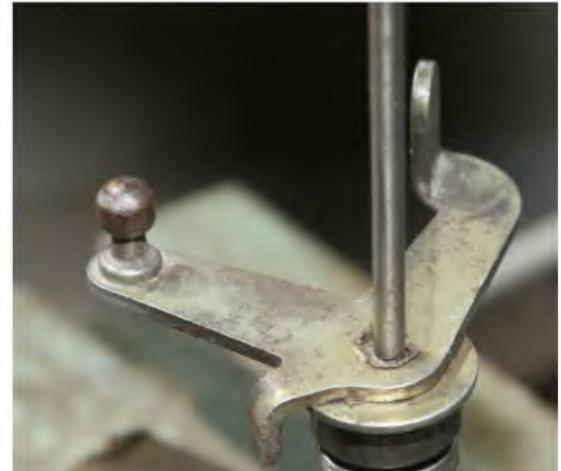
Dans un premier temps , si les carburateurs n'ont pas été démontés récemment ,on va pulvériser du dégrippant avec action par le froid afin d'augmenter les chances de réussite des opérations : privilégier les vis de papillons , les axes et la proximité des roulements. Laisser agir le temps du repas par exemple.
