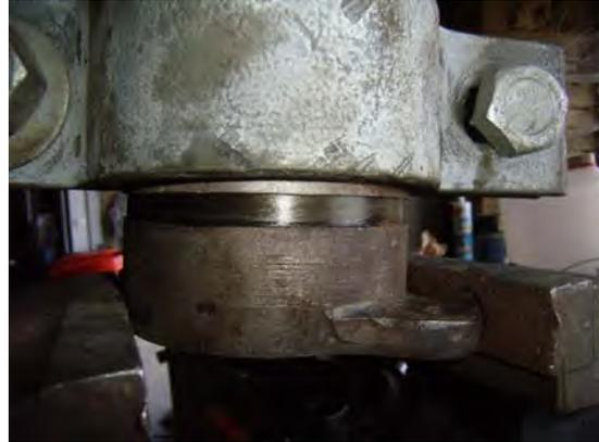
Il est maintenant temps de vidanger celui-ci , par le trou de remplissage , en manœuvrant le bras pour aider l'huile à sortir. Ceci a aussi pour effet de faire sortir le manchon thermostatique et la vis clapet.
