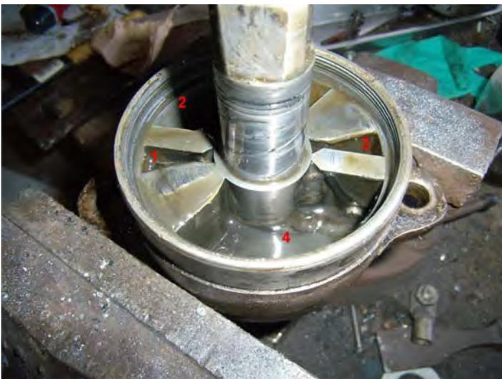
Les parties 2 et 4 communiquent directement par le trou 2-4 qui se trouve sous la vis clapet (celle-ci n'a pas d'influence sur la communication entre 2 et 4)
