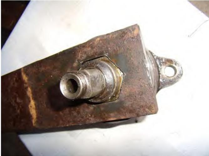
Ensuite, blocage de la pièce dans l'étau, blocage de la clé en position et tentative de desserrage à l'aide d'un bras de levier de 1m : rien ne se passe si ce n'est l'établi qui commence à suivre le mouvement. Nouvelle tentative avec un bras de levier de 2m, ça vient, la pièce commence à tourner puis se dévisse.
