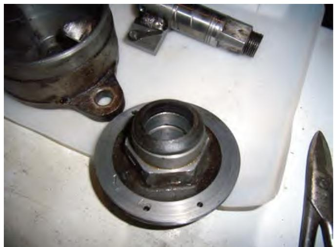
Trois billes permettent le transfert de l'huile du réservoir vers l'intérieur. Deux sont visibles sur la photo (1 et 2) le trou (3) ne débouche pas.
