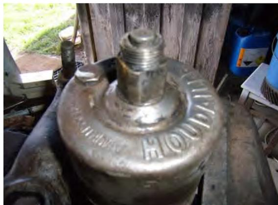
L'idéal pour ce démontage serait de faire une pièce au tour , de diamètre légèrement inférieur et de 5cm de hauteur pour serrer le réservoir sans risque.
