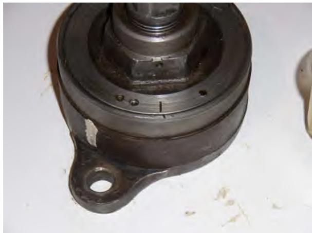
Huilage du joint et mise en place, on peut voir que l'axe dépasse de moins de 2mm . Le réservoir est mis en place à la presse après avoir enduit le corps de pate à joint , bien que cela ne soit pas indispensable , pour une première je préfère assurer le coup.
